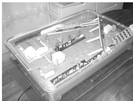
図-7 ジオラマを用いた実験装置で液状化現象を観察する。
